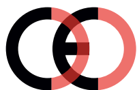
Falsk CE-mærke (for tæt på hinanden)
